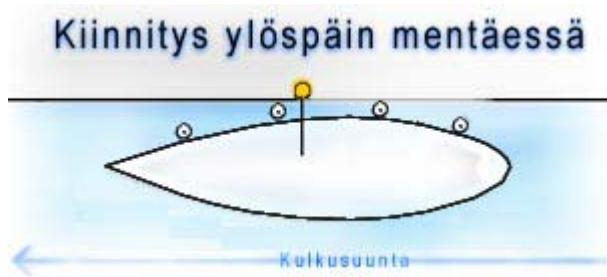
**Швартовка судна, идущего вверх:** швартовка со средней части судна крепко прямым канатом к плавучему рыму, установленному в стенке шлюза. Если в шлюзе нет других судов, следует швартоваться с нижних ворот к первому незанятому плавучему рыму.
